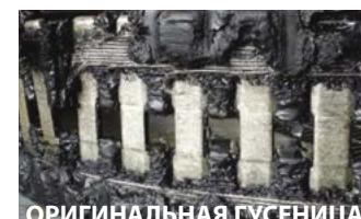
После 196 часов испытаний гусеницы конкурента вышли из строя, в то время как грунтозацепы Camso были в хорошем состоянии по всей окружности гусеницы.
